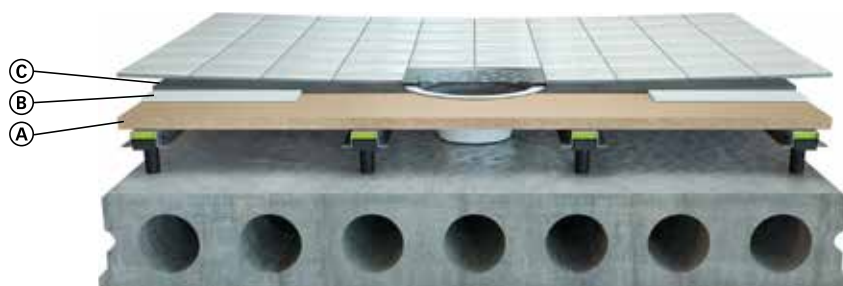
A: Gulvsponplate 22 mm. B: Plate av uorganisk materiale. C: Fallsparkling.
